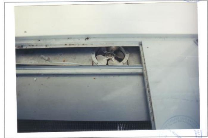
Bild 20a: Detail Korpus 1 innen mit Verdampfer und Lüfterrad
