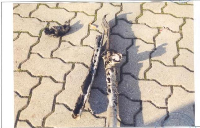
Bild 13a: verbranntes und angeschmortes Tauwasserabflussrohr
