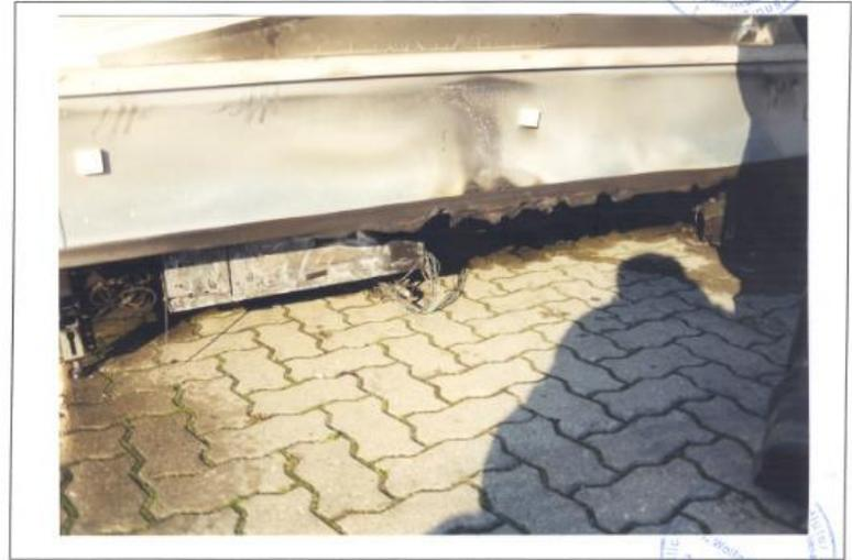
Bild 15: Klemmkasten 3, verbrannte Kabelreste und geschmorter Leiste an Seite von Korpus 1
