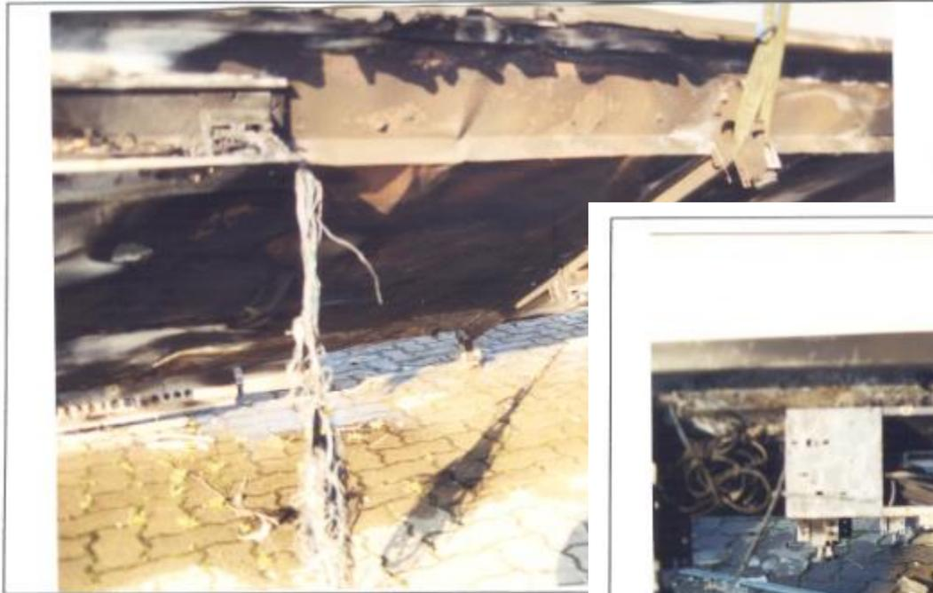
Bild 18a: ausgebrannter Klemmkasten 1, verbrannte Kabelreste
