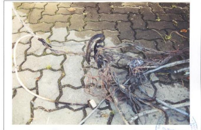
Bild 7a: ausgebrannte Kabelreste von Korpus 1
