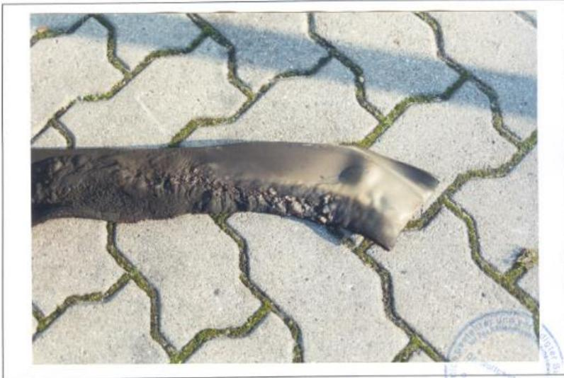
Bild 12a: Detail zu verbrannter und angeschmorter Abdeckschiene
