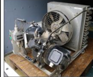
Verflüssigersatz DH2-10-055/06 mit R12/R 413A vom VEB Maschinen- und Apparatebau Schkeuditz (1988)
